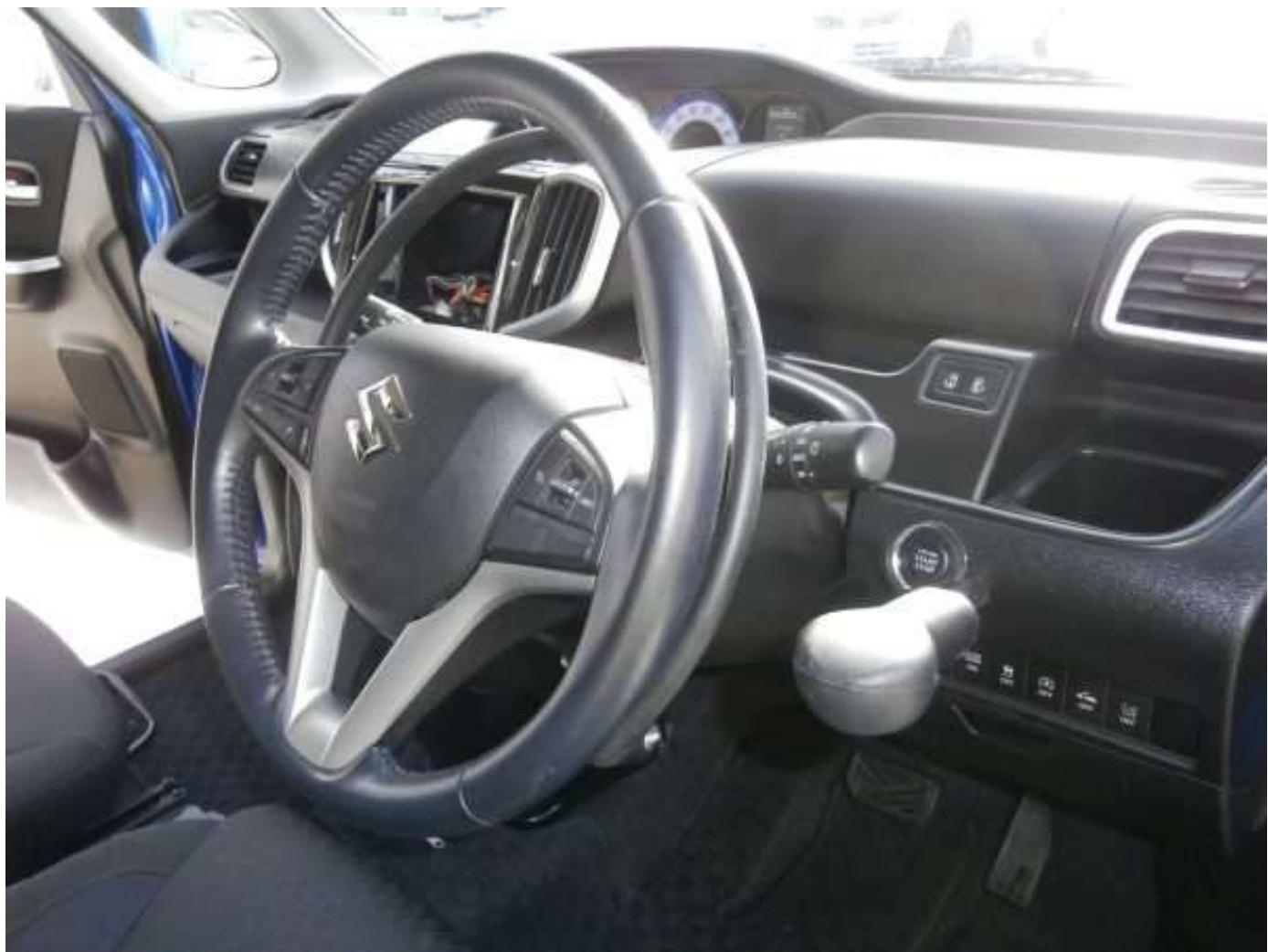
足を使わず両手のみでの運転を可能にする手動運転装置
