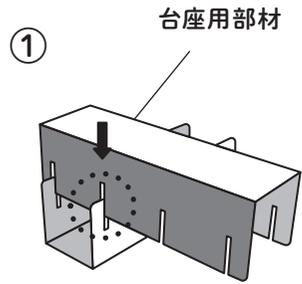
図のように溝部分に【台座用部材】を差し込む。
